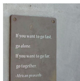
真鍮 (屋外設置で3年経過)
